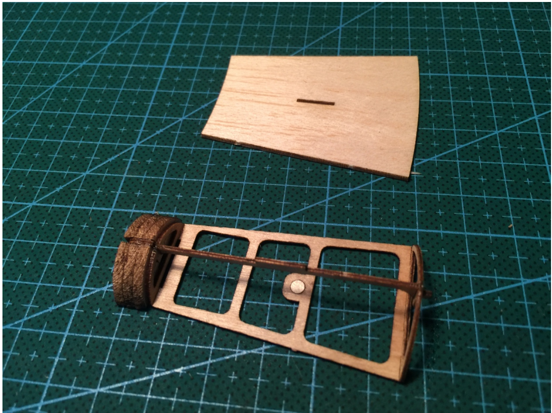
18、安装引擎盖蒙板。先组合中心卡榫，再向两侧弯曲蒙制。
