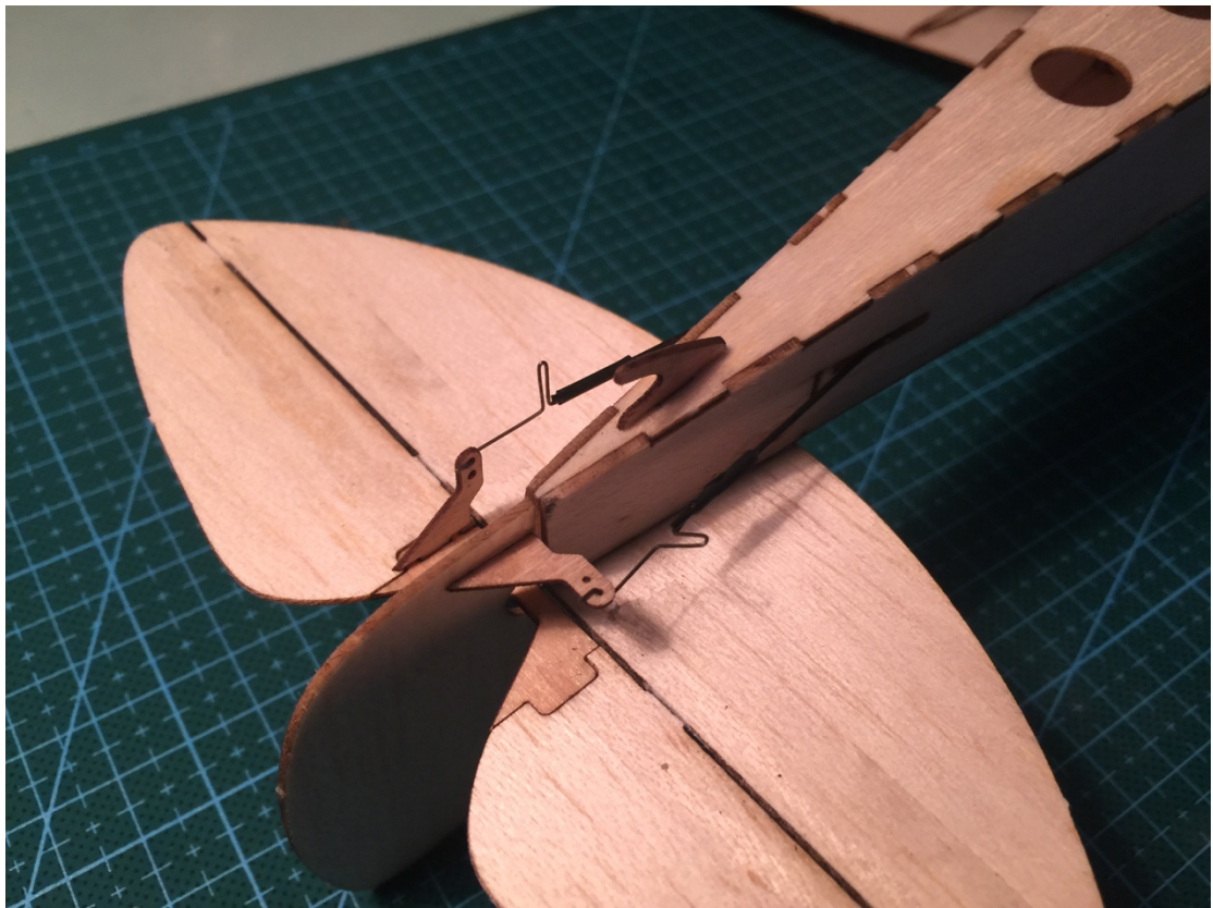
44、安装舵角。截取长度适宜的拉杆，连接舵角与舵机。
